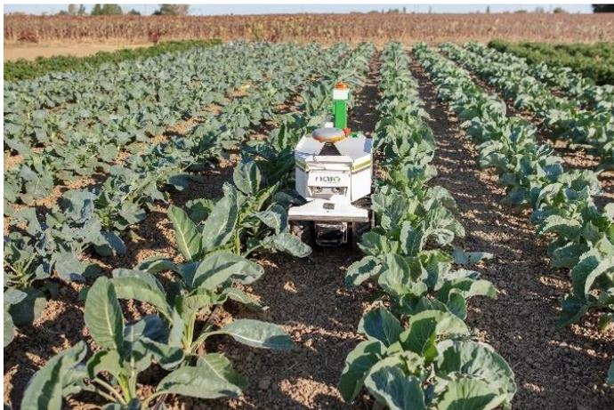
robot de Naïo Technologies destiné aux maraîchers et déjà utilisé par plus de 120 agriculteurs. L'objectif est d'augmenter son autonomie de plus de 30 %. Le deuxième projet consiste à créer des bornes de recharges solaires pouvant être utilisées directement dans les champs. Dans le domaine de la robotique agricole, ces bornes sont une première mondiale.
