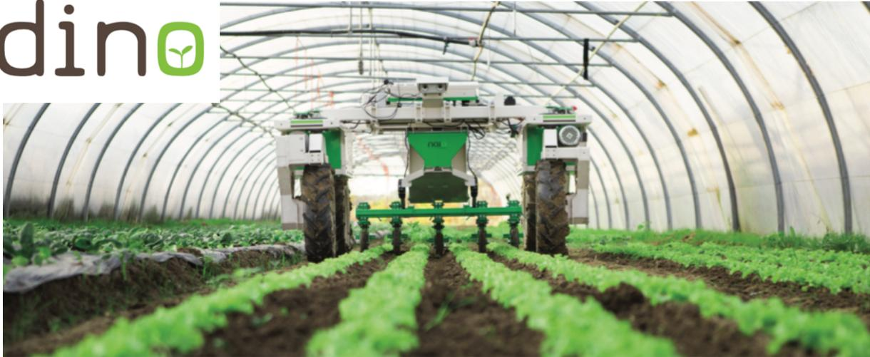
Conçu par Naïo Technologies pour le désherbage de planches de légumes et l'assistance aux maraîchers, les premiers tours de roues du [robot Dino](#) ont eu lieu en cette fin de saison 2016. Basé sur le guidage laser et caméra de leur célèbre robot Oz, Dino est un robot électrique autonome, pouvant également se guider au GPS.
